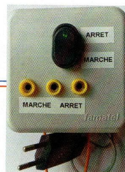
Module HT avec prise résistive pour décharge des condensateurs
